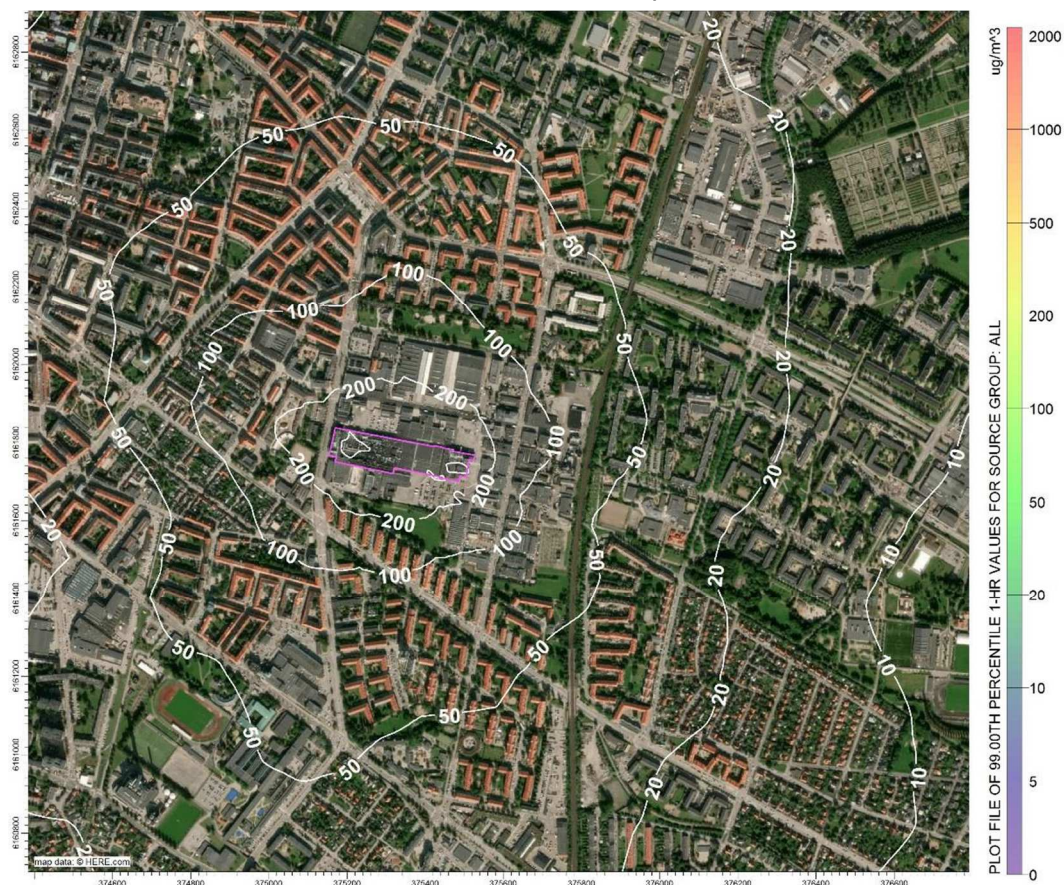
Figur 19 Beräknade halter från verksamheter. Etanol normaldrift timmedelvärde 99-percentil.
