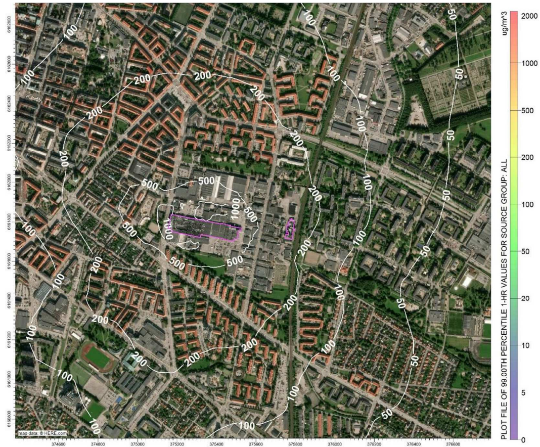
Figur 21 Beräknade halter från verksamheter. Etanol max timmedelvärde 99-percentil.
